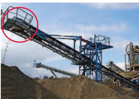
Los sistemas de cintas transportadoras grandes pasan a menudo por largas distancias y varios niveles y son **difícilmente accesibles**. La relubricación óptima debería realizarse con la instalación en marcha. Los puntos de lubricación en los puntos de transferencia normalmente solo se pueden alcanzar a través de rejillas o plataformas de trabajo, y a menudo se **descuidan**. La **prevención de accidentes** y la **seguridad en el trabajo** deben estar garantizadas en todo momento.
