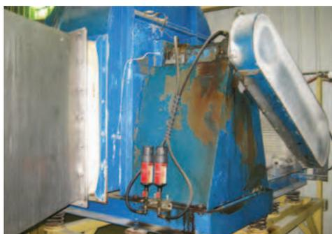
Pinza de montaje 30 mm
